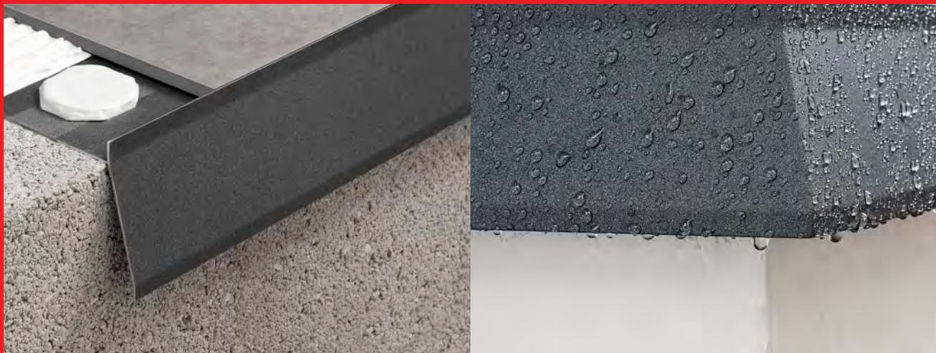
Perfil vierteaguas de amplia cara vista fabricado en aluminio lacado, ideal para rematar el perímetro de terrazas, balcones y alféizares. El exclusivo diseño de su goterón, ranurado en toda su longitud, aumenta su eficacia para canalizar el agua lejos de la pared, evitando así que el agua caiga sobre la fachada y provoque filtraciones.
